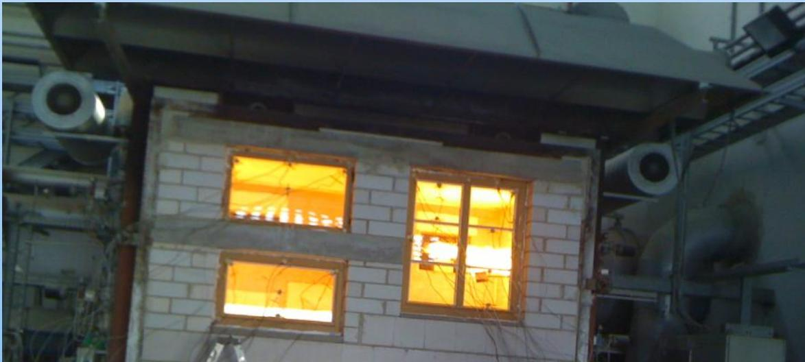
Nach vielen Nachfragen von Architekten und Bauherren hat Histoglas ein Brandschutzfenster als Holz-Sprossenfenster entwickelt und zur Serienreife gebracht. Mit einem Rahmen aus Eiche und speziellen Brandschutzgläser in Kombination mit entsprechenden Dichtungen erfüllt dieses Fenster die Vorgaben eines Brandschutzfensters F30 trotz den vergleichweisen filigranen Profilen von 52 mm.
